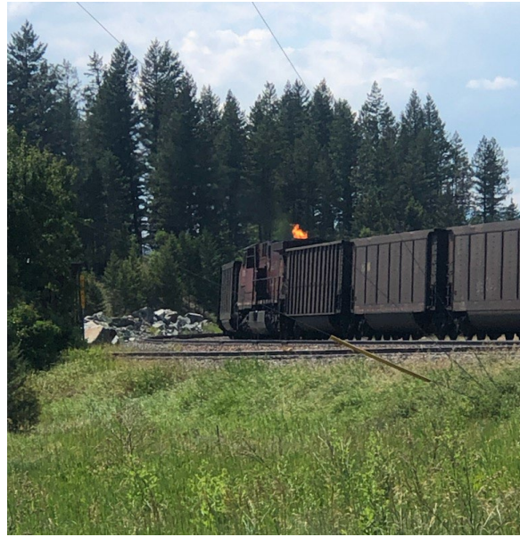
Figure 2. Incendie dans la cheminée d'échappement de la locomotive télécommandée en milieu de train (Source : Résident d'Elko)
