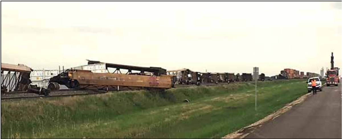
Figure 2. Wagons intermodaux déraillés
