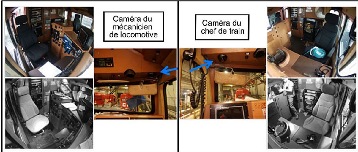
Figure E4. Chemin de fer C : Emplacement des caméras dans la cabine et images de jour (en haut) et de nuit (en bas) (Photos : Chemin de fer C)
