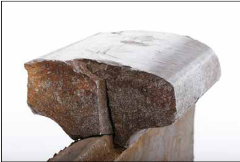
Figure 17. Vue de la fissuration verticale longitudinale du champignon de la section de 4 pouces du rail d'origine est
