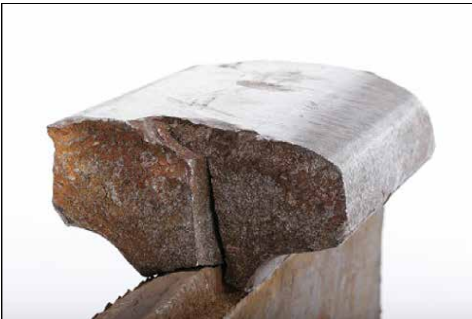
Figure 8. Côté intérieur de la fissuration verticale longitudinale du champignon du fragment récupéré du champignon du rail d'origine
