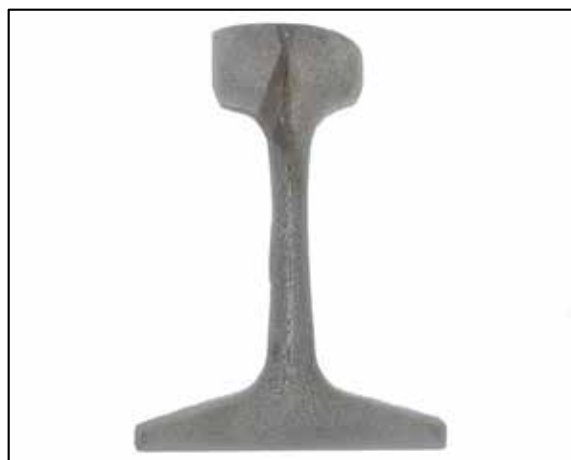
Figure A2. Attaque macrographique d'une coupe transversale du rail nord avec fissuration de l'âme et fissuration verticale longitudinale du champignon
