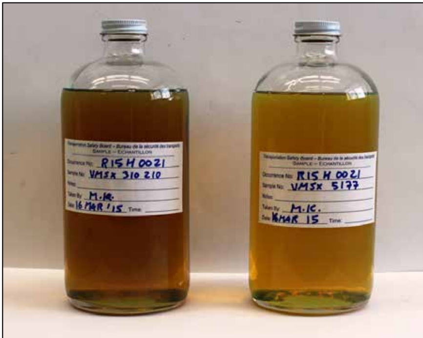
Figure 20. Échantillons de pétrole brut prélevés des wagons-citernes VMSX 310210 et VMSX 5177
