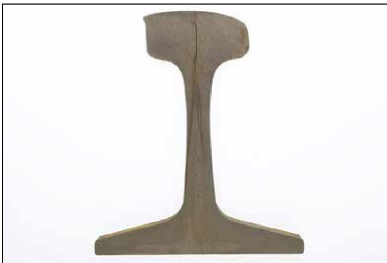
Figure 18. Coupe transversale du rail à 3 pouces à l'ouest de la soudure aluminothermique présentant une séparation physique dans le champignon et une fissuration de l'âme
