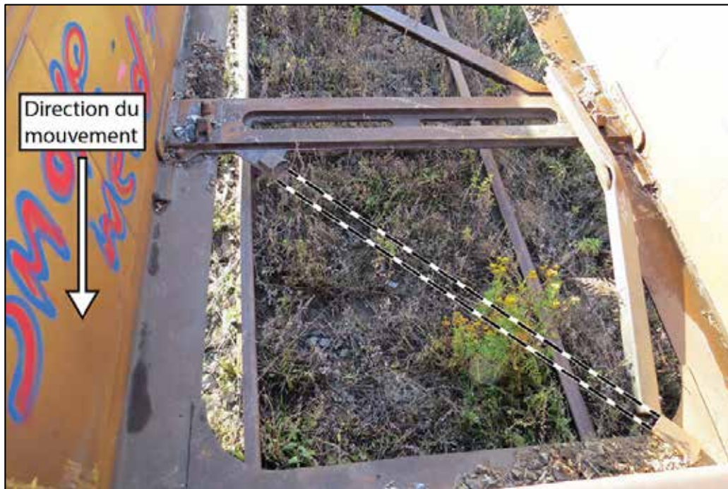
Photo 1. Première membrure diagonale de plancher du wagon (position originale montrée en pointillés)
