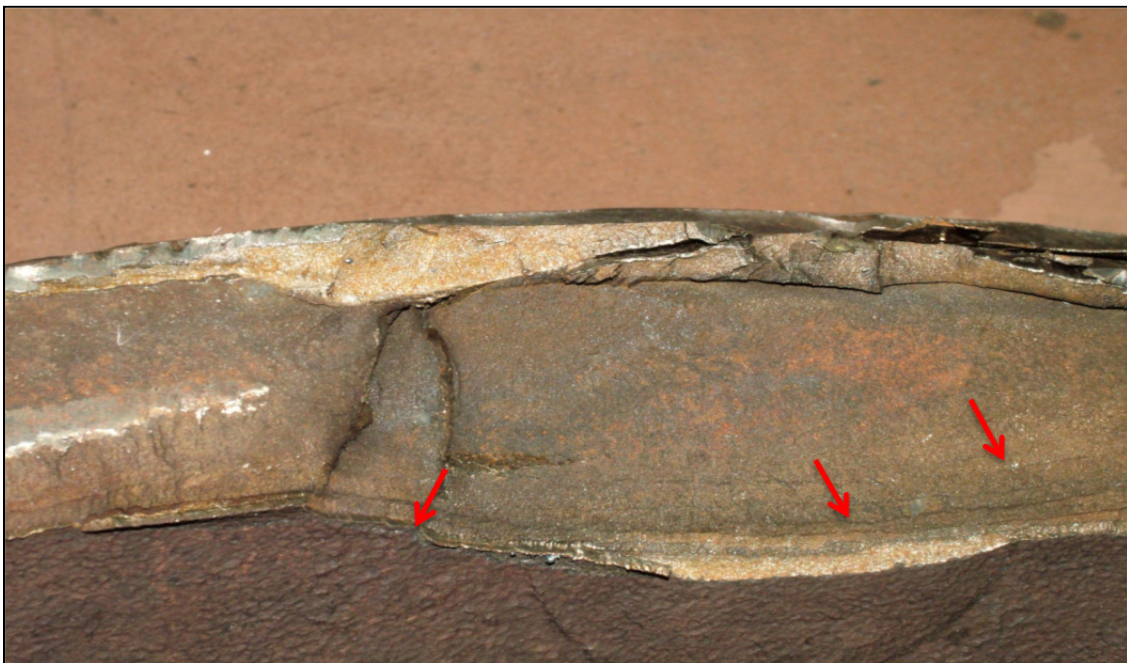
Photo 2. Origine de la fissure verticale dans la jante de la roue. Notez les ondulations de fatigue (flèches).
