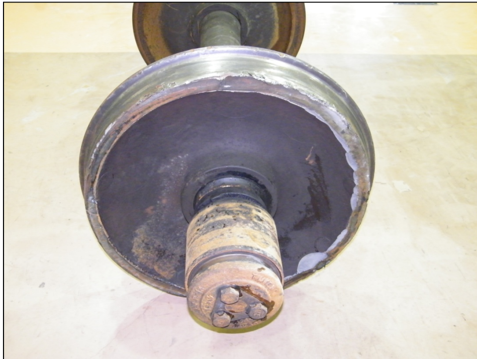
Photo 1. Essieu monté avec la roue brisée et sa roue conjuguée
