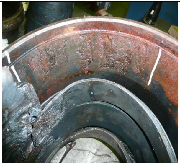
Photo 3. Écaillage sur le chemin de roulement situé du côté intérieur de la cuvette L4 (caractéristique)
