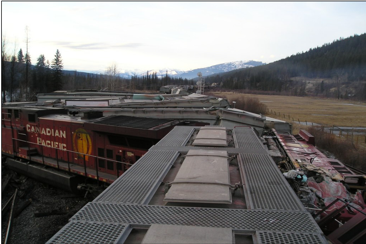
Photo 1. Dommages causés par le déraillement à des wagons des trains 300 et 671
