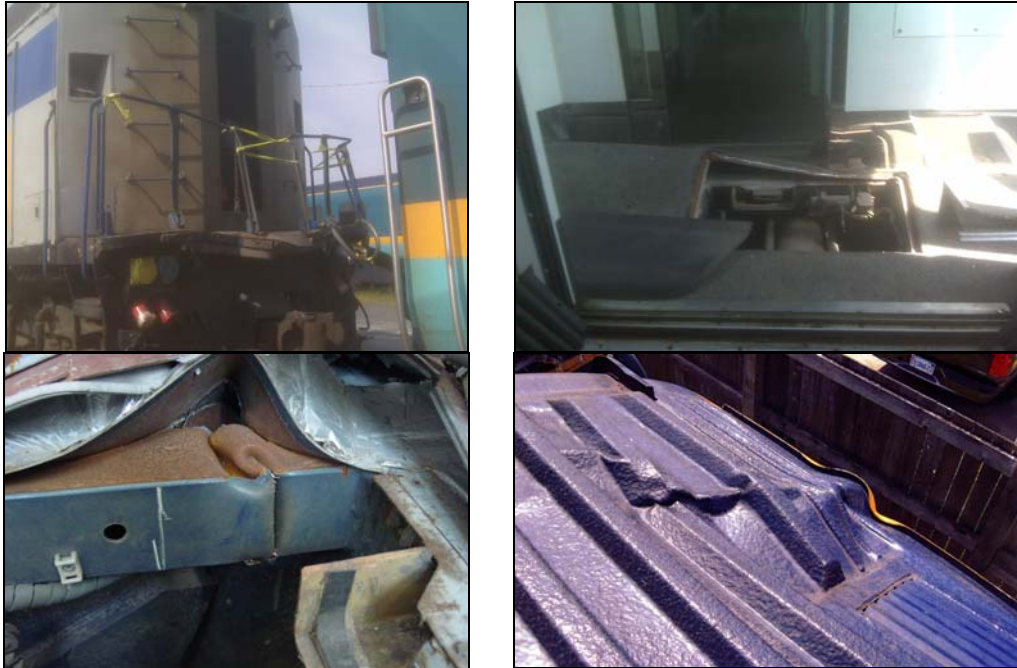
Photo 3. Dommages subis par le matériel roulant de VIA (en haut à gauche : dommages causés à un bout de la locomotive, en haut à droite : flambage du plancher de la plate-forme d'une voiture, en bas à gauche : écrasement de la zone déformable, en bas à droite : dommages causés au toit d'une voiture)
