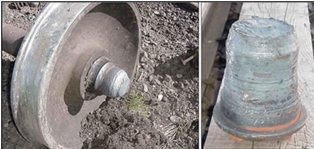
Photo 2. Photos de la roue L3 et du capuchon de la fusée d'essieu surchauffée du wagon XPWX 2007, montrant les dommages causés par la surchauffe d'un roulement à rouleaux
