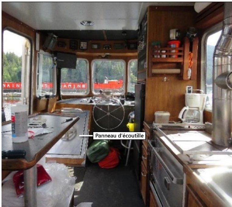
Figure 5. Vue de la timonerie montrant l'écouille menant aux quartiers (Source : tierce partie, avec annotations du BST)
