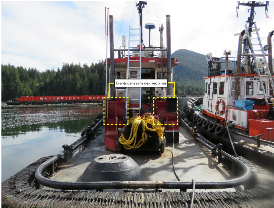
Figure 2. Vue de l'arrière de l' Ingenika montrant les événements d'échappement de la salle des machines (Source : tierce partie, avec annotations du BST)
