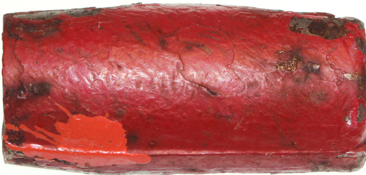
Figure 10. Partie brisée du manchon de sertissage tribord arrière provenant de l'extrémité supérieure de l'élingue (Source : BST)
