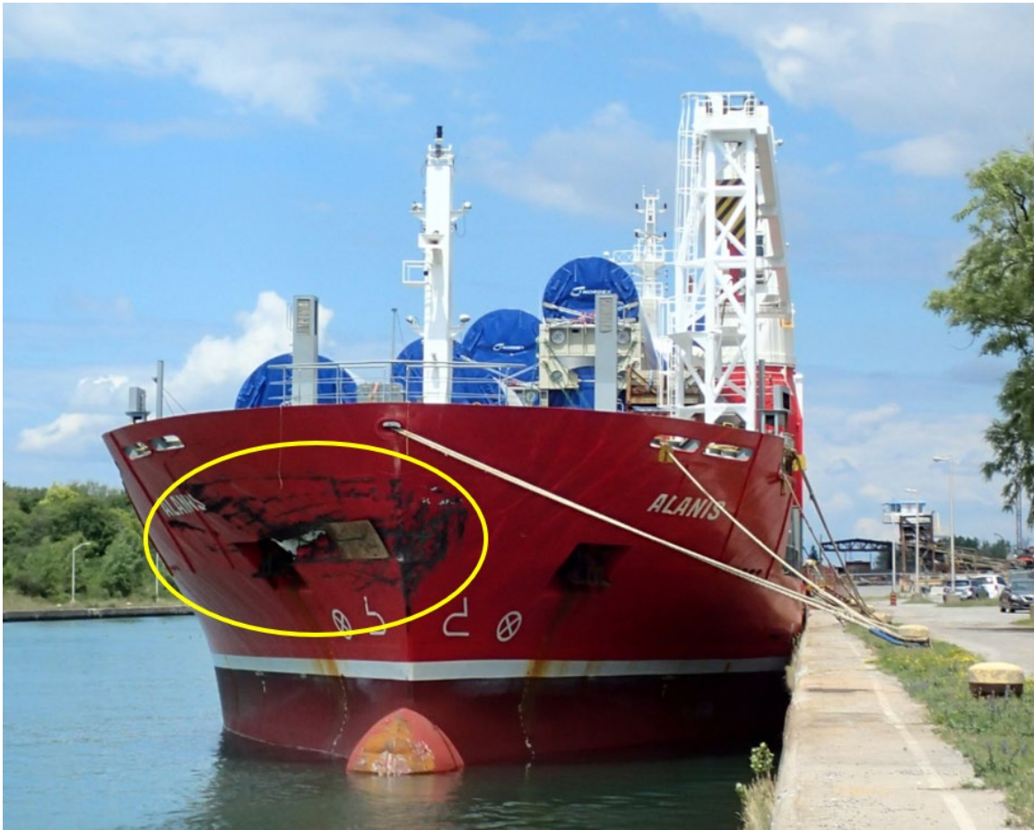
Figure 10. Dommages à la partie avant tribord de la coque de l'Alanis (encerclé) (Source : BST)
