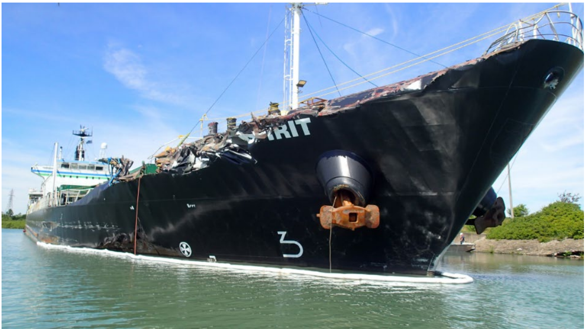
Figure 9. Dommages à la partie avant tribord de la coque du Florence Spirit (Source : BST)
