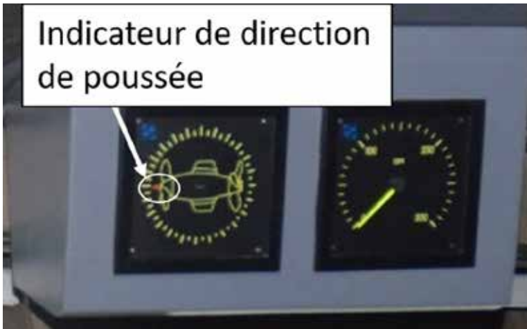
Figure 9. Indicateur de direction de poussée (gauche) et compte-tours (droite). Le pointeur triangulaire rouge est indiqué avec une cercle.
