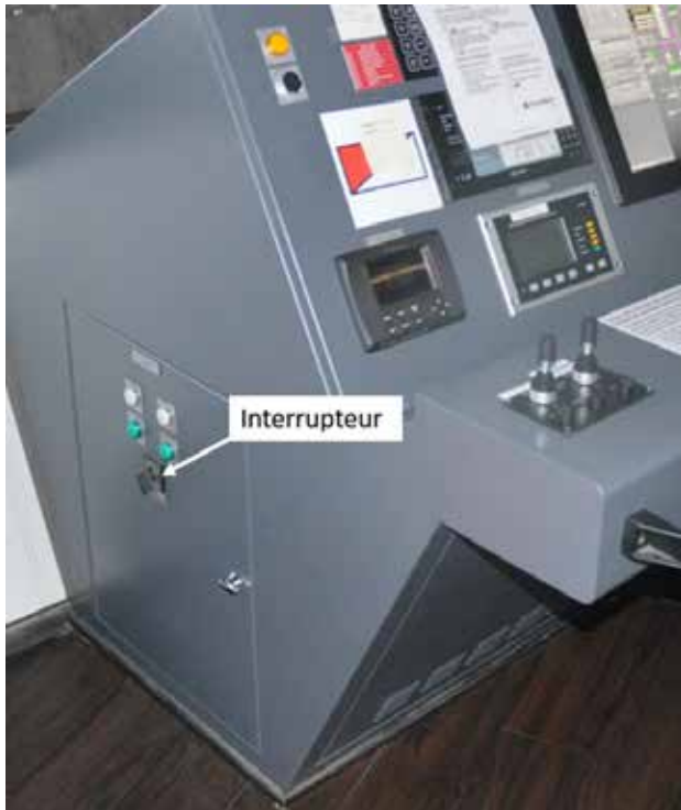
Figure 2. Emplacement de l'interrupteur
