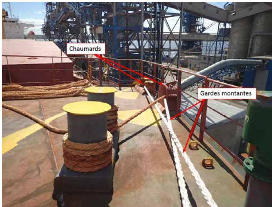
Figure 4. Photo du Nord Quebec le long du quai 16 au port de Trois-Rivières (Québec) montrant la configuration d'amarrage sur le pont de gaillard d'avant et l'emplacement des chaumards et des gardes montantes de l'avant à la suite de l'événement à l'étude
