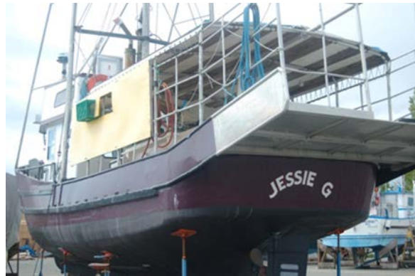
Photo 2. -Rallonge arrière, cage en aluminium et protecteur contre le gros temps.
