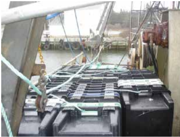
Photo 4. Bacs de manutention imbriqués sur le pont supérieur le long de la rambarde côté tribord.
