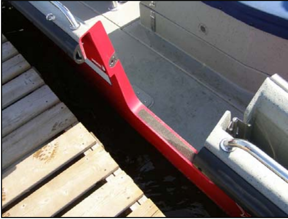
Photo 2. Porte latérale ouverte vers l'intérieur
