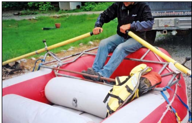
Photo 1. Vue de l'arrière montrant le cadre de conduite avec ses avirons fixés à des tolets. On y voit la position du chef d'excursion et les chambres à air transversales de flottaison.
