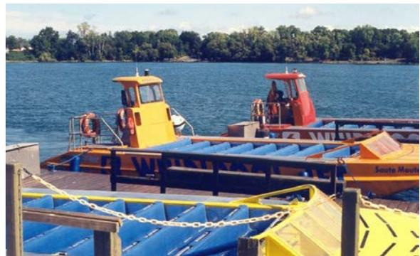
Le compartiment passagers comprend sept rangées de bancs coussinés de mousse et montés sur des ressorts pour amortir les chocs, protégés par des caisses de flottabilité latérales compartimentées qui sont intégrées au carénage, au fond plat et aux bords latéraux. Juste devant chaque rangée de sièges, il y a, à portée de bras, une barre d'appui horizontale en acier inoxydable à laquelle les passagers peuvent se cramponner pour rester assis
