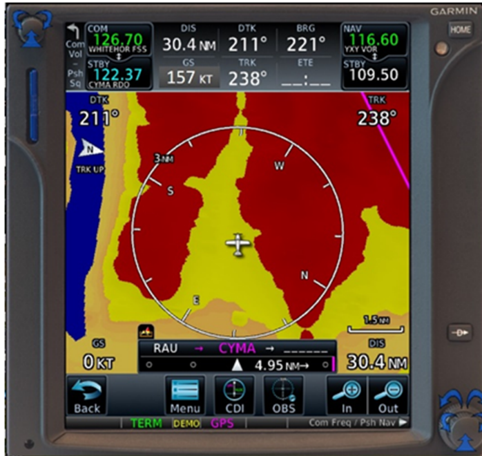
Figure 2. Affichage de simulateur de GTN 750 montrant l'avertissement de terrain en fonction des données GPS environ 90 secondes avant l'impact à 4000 pieds ASL (Source : Garmin, avec annotations du BST).
