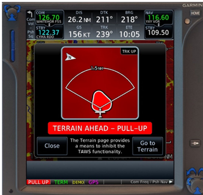
Figure 2. Affichage de simulateur de GTN 750 montrant l'avertissement de terrain en fonction des données GPS environ 90 secondes avant l'impact à 4000 pieds ASL (Source : Garmin, avec annotations du BST).
