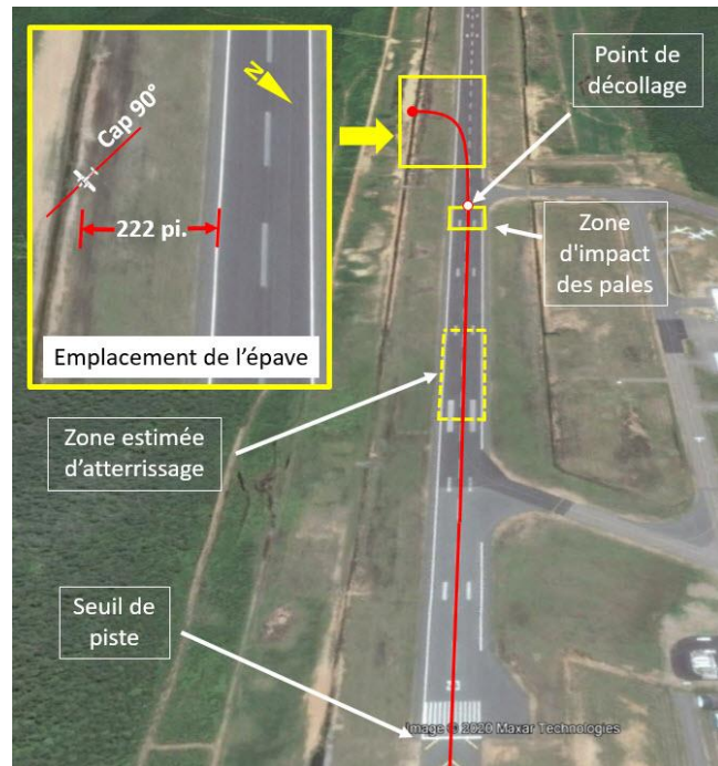
Figure 9. Piste 23 à CYRQ, avec image en médaillon montrant l'emplacement de l'épave (Source : Google Earth, avec annotations du BST)
