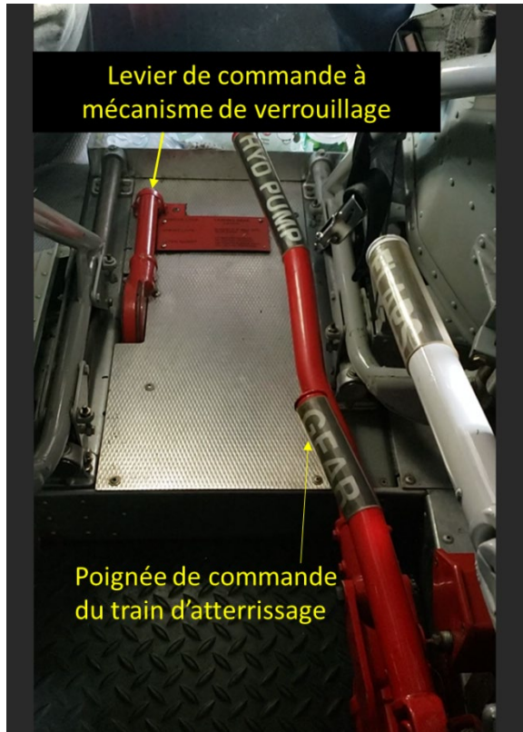
Figure 3. Poignée de commande du train d'atterrissage principal et levier de commande à mécanisme de verrouillage (Source : BST)
