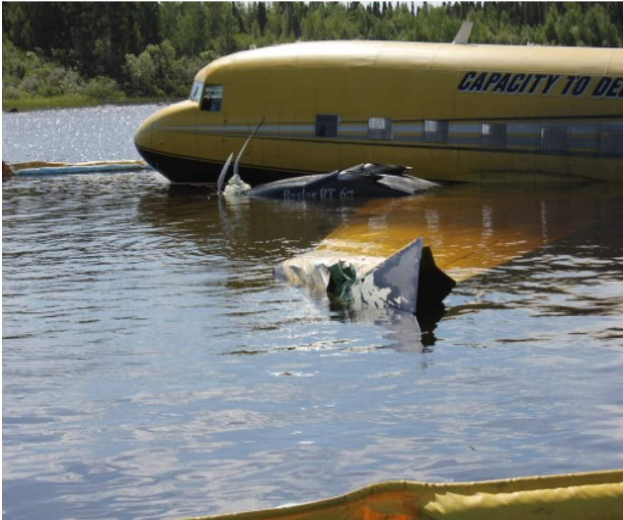
Figure 6. Extrémité de l'aile gauche de l'aéronef à l'étude présentant des dommages par écrasement (Source : BST)
