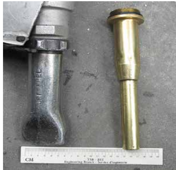
Photo 3. Exemple de bec en éventail (à gauche) et de bec à diamètre réduit (en laiton)
