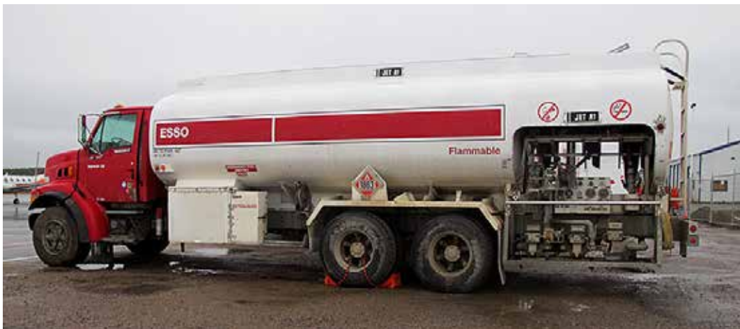
Photo 1. Véhicule distributeur de Jet-A1
