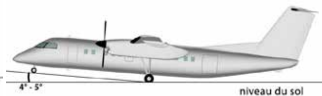
Figure 3. Assiette du DH8C à l'atterrissage
