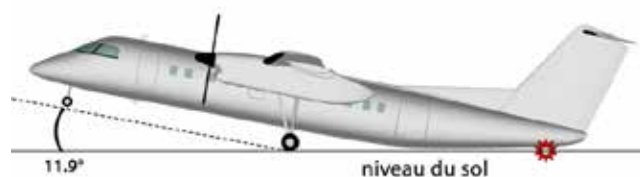
Figure 4. Impact du fuselage, amortisseurs oléopneumatiques du train en extension
