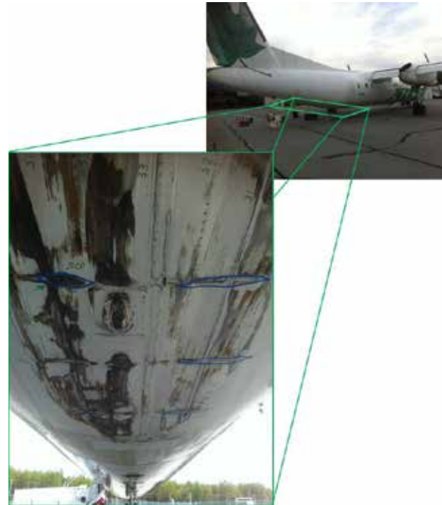
Photo 2. Dommages observés sous la partie inférieure du fuselage (source : Jazz Aviation LP)
