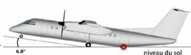
Figure 5. Impact du fuselage, amortisseurs oléopneumatiques du train comprimés
