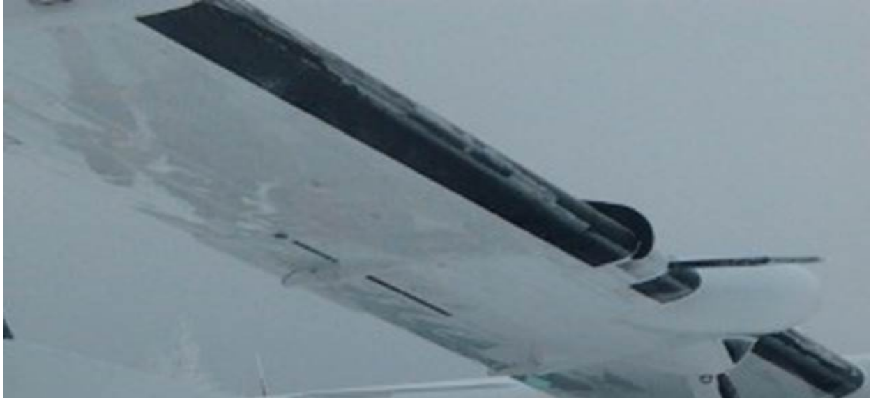
Photo 1. Glace sur le bord d'attaque d'une aile, avant le vol ayant mené à l'accident
