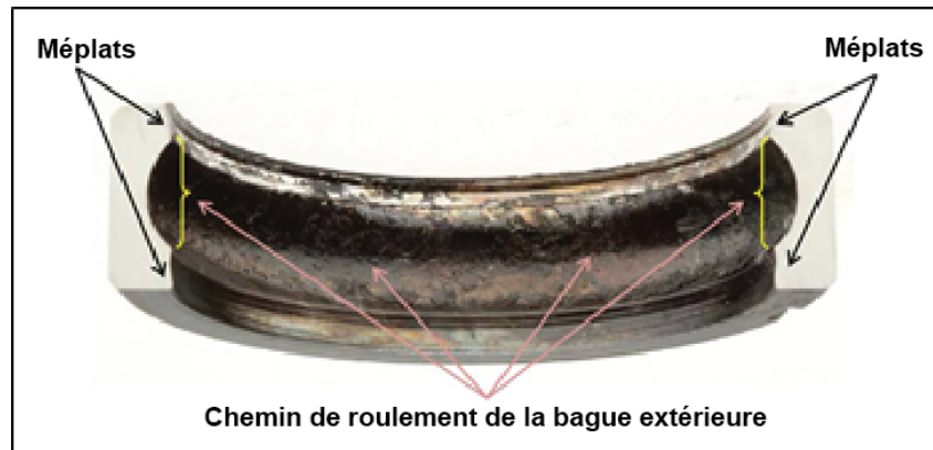
Photo 1. Méplats endommagés sur le chemin de roulement de la bague extérieure
