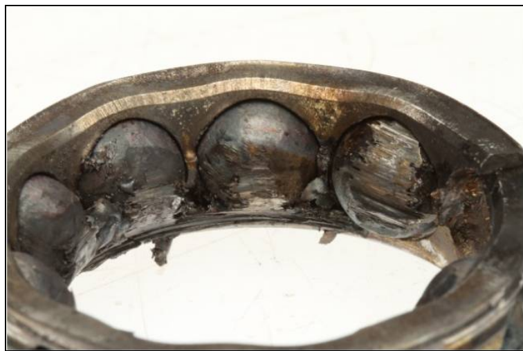
Photo 2 Dommages aux billes et à la cage de roulement à billes
