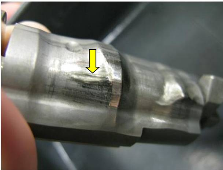
Photo 6. Usure sur la came 3D
