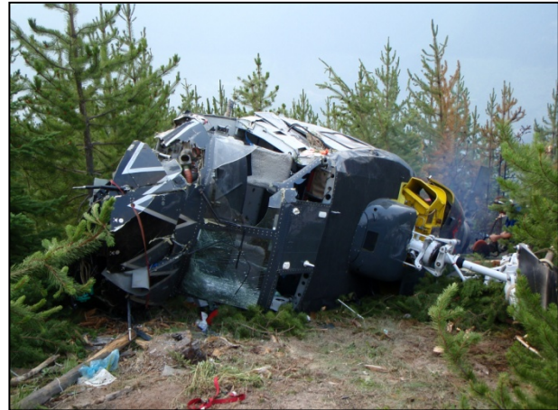
Photo 2. Dommages au poste de pilotage et à la cabine
