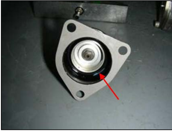
Photo 3. Débris dans la chambre à membrane de pression différentielle
