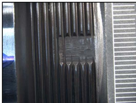
**Photo 3.** Filets de l'arbre de la turbine basse pression
