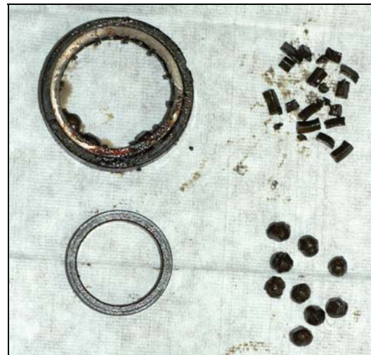
Photo 3. Composants du palier no 3 au démontage
