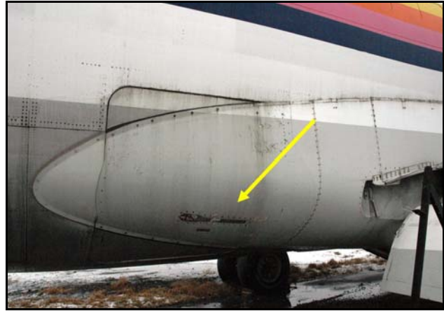
Photo 2. Poignée de la porte de soute arrière rentrée
