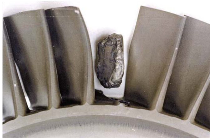
Photo 1. Restes de l'aube mobile brisée
