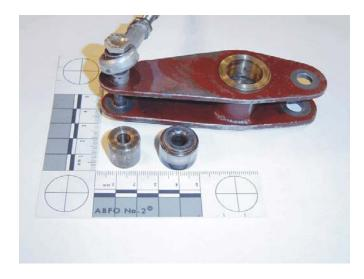
sur une bague intérieure. Le diamètre du galet du roulement portant la référence YCRS-12 est supérieur à celui du galet installé.
