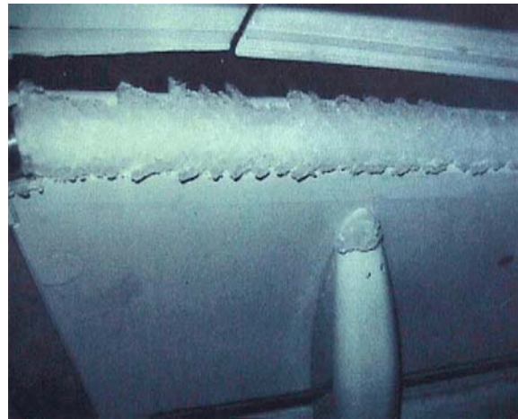
Photo 1. Accumulation de givre sur les bords d'attaque des volets principaux d'un Airbus A321 au cours de l'événement survenu en décembre 1998
