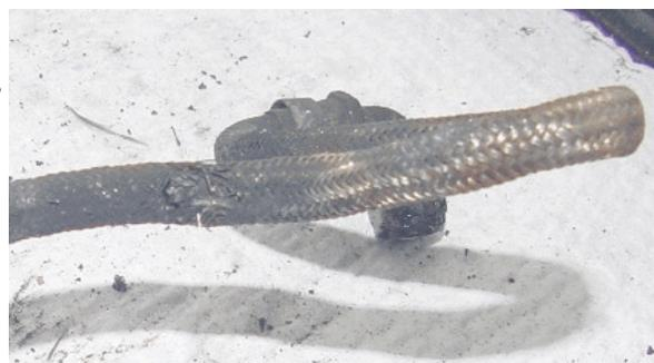
Seuls le compartiment moteur et le compartiment à bagages qui se trouve directement sous le plancher du compartiment moteur ont été la proie de l'incendie. Tous les faisceaux électriques et l'interface des indicateurs du moteur ont été détruits dans l'incendie. Le capot qui protège le ventilateur de refroidissement du démarreur/alternateur s'est détaché du boîtier du générateur. Le capot était maintenu sur le ventilateur de refroidissement par la conduite de carburant coincée. Les pales du
