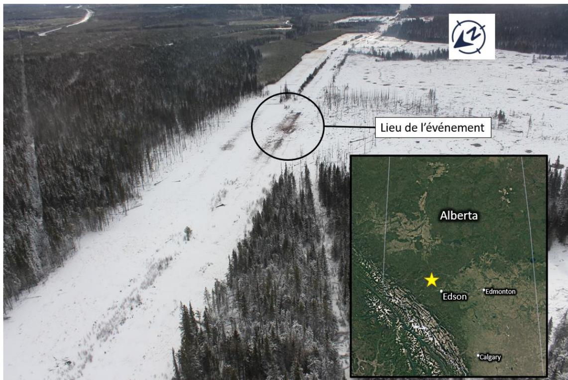
Outre la conduite principale Grande Prairie NPS 36, l'emprise compte 2 autres gazoducs parallèles de NGTL : un gazoduc de 42 po et un autre de 48 po qui transportent du gaz naturel dans la même direction. Une conduite de 8 po<sup>3</sup> et une conduite de 3 po<sup>4</sup> appartenant à des compagnies tierces sont également parallèles aux conduites de NGTL.
