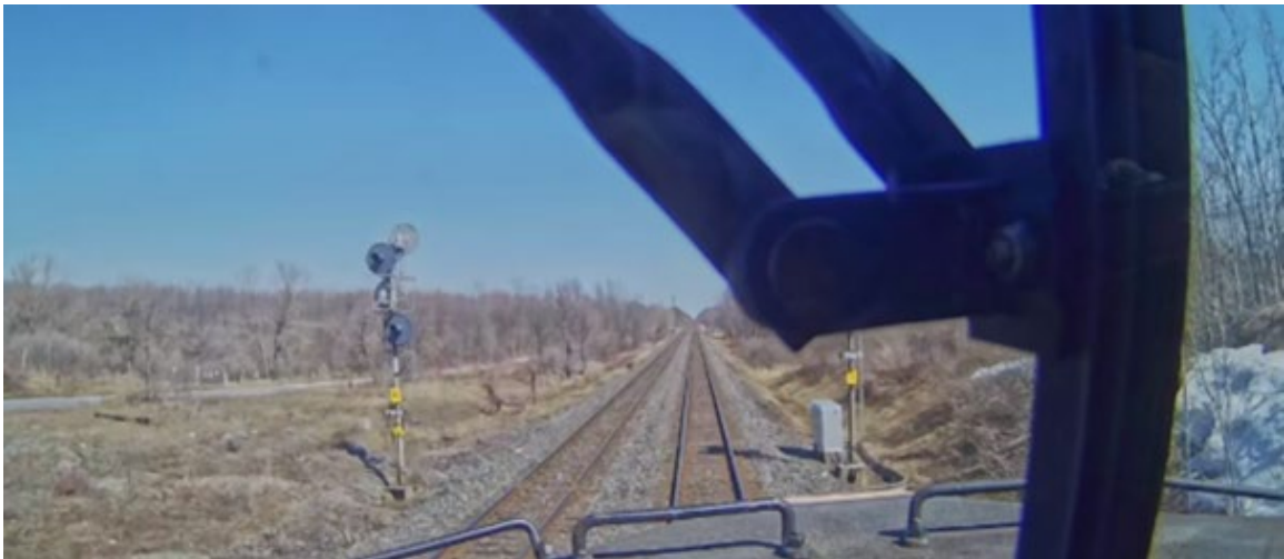
Figure 4. Vue de la caméra orientée vers l'avant du train CN 372, montrant que la vue est obstruée par un essuie-glace (Source : Canadien National)
