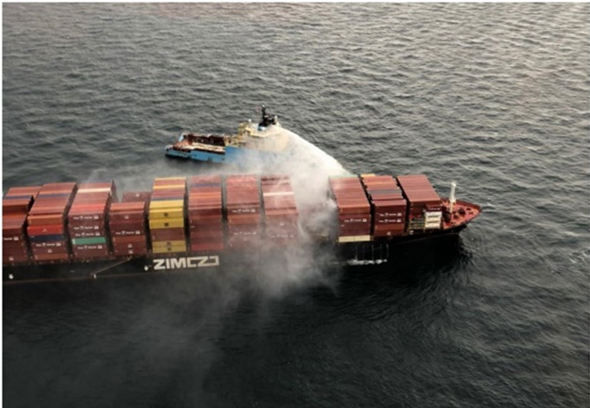
Figure 3. Le Maersk Trader procédant au refroidissement du périmètre (Source : Resolve Marine)
