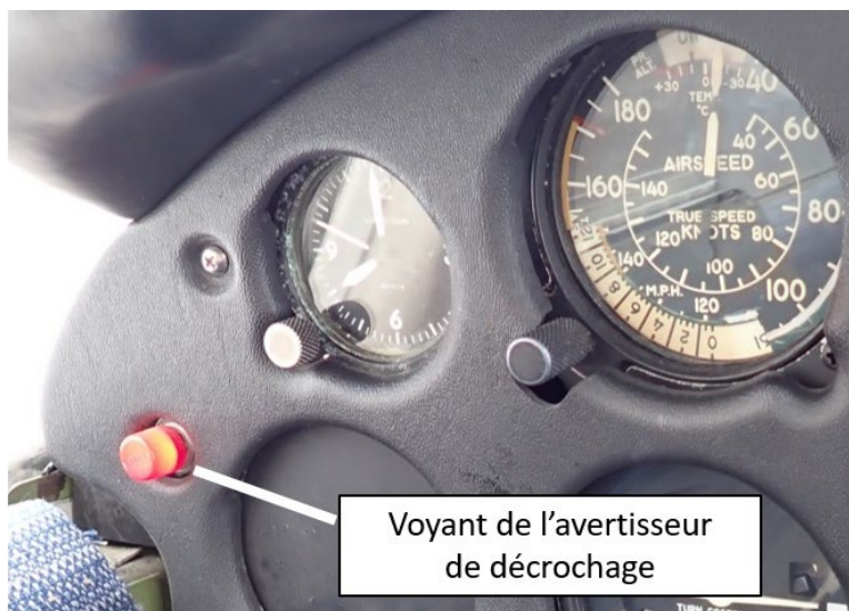
Figure 3. Voyant d'avertissement de décrochage allumé dans un aéronef semblable à l'aéronef à l'étude (Source : BST)
