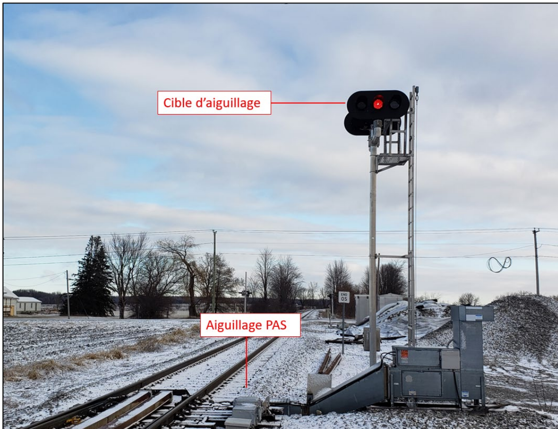
Figure 6. Aiguillage et cible électronique à l'extrémité nord de la voie d'évitement Carr (Source : BST)
