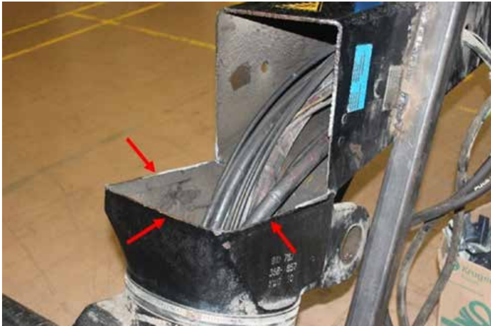
Figure 3. Emplacement de la soudure rompue de la colonne de la grue indiqué par les flèches rouges
