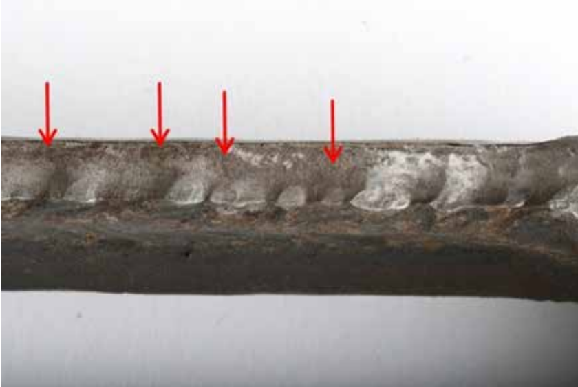
Figure 7. Surface de rupture oxydée, indiquée par les flèches rouges
