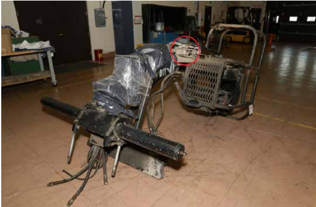
Figure 10. Grue avec une pièce brisée du cadre de la nacelle (encerclée en rouge)
