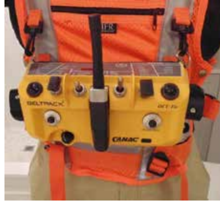
Figure 5. Télécommande de locomotive fixée à la veste d'un opérateur
