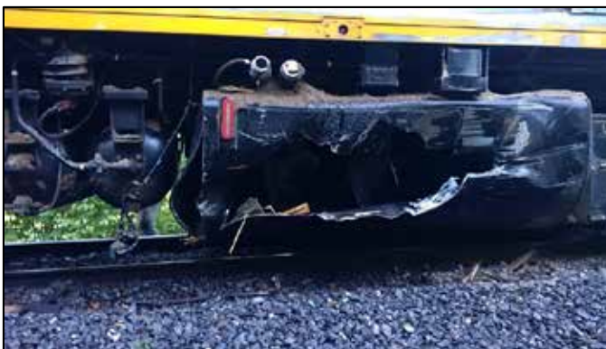
Figure 6. Réservoir de carburant de la locomotive VIA 6413
