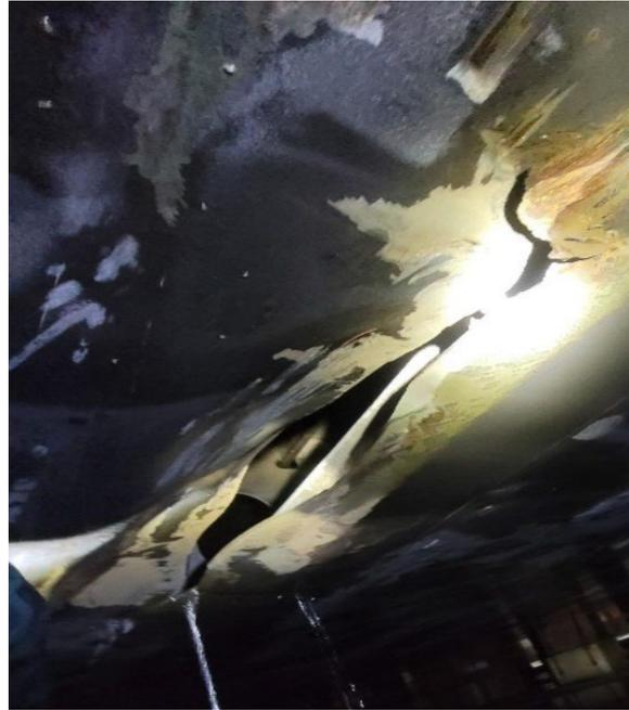
Figure 4. Avaries au navire, vues de l'intérieur de la citerne de ballast tribord n° 3 (Source : Coastal Shipping Limited)
