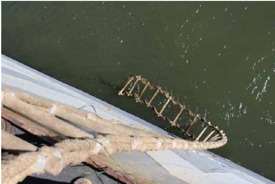
Figure 2. Vue de dessus de l'échelle de revers qui pendait sur le côté bâbord de l'Amazoneborg, près des marques de tirant d'eau au milieu du navire
