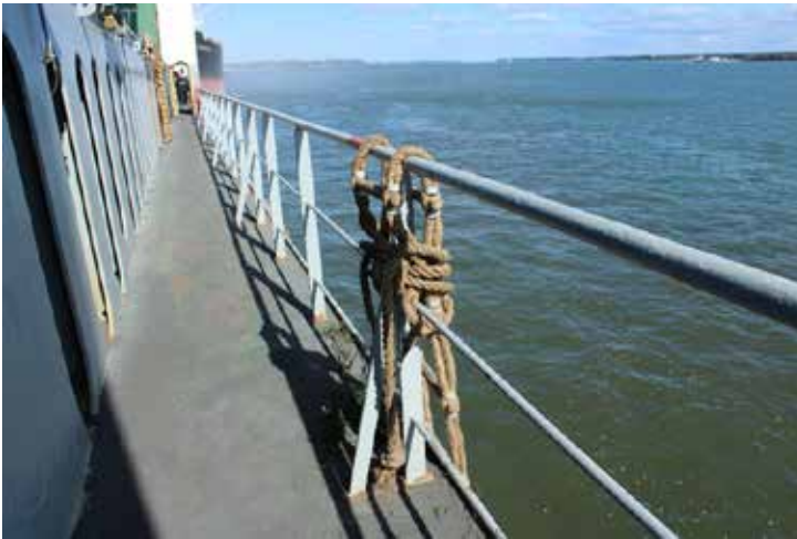
Figure 6. Installation de l'échelle de revers à la rambarde à bord de l'Amazoneborg au moment de l'événement
