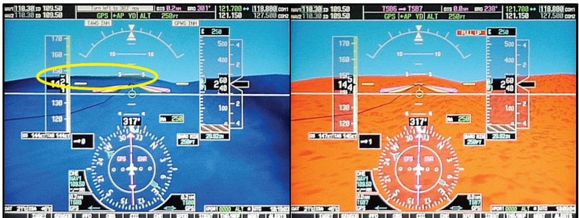
Figure 5. Comparaison de la géométrie des textures à la surface représentant l'île Addenbroke, comme affiché sur l'écran de vol principal de l'aéronef, avec la fonction d'évitement d'obstacle à balayage frontal bloquée (image de gauche) et la fonction d'évitement d'obstacle à balayage frontal activée (image de droite) lorsque l'altitude est de 250 pieds au-dessus du sol (Source : BST)
