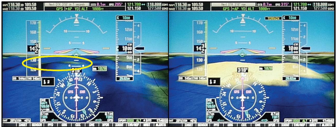
Figure 4. Comparaison de la géométrie des textures à la surface représentant l'île Addenbroke, comme affiché sur l'écran de vol principal de l'aéronef avant l'activation de l'avertissement de relief (image de gauche) et immédiatement après l'activation de l'avertissement de relief (image de droite) lorsque l'altitude est de 1000 pieds au-dessus du sol (Source : BST)
