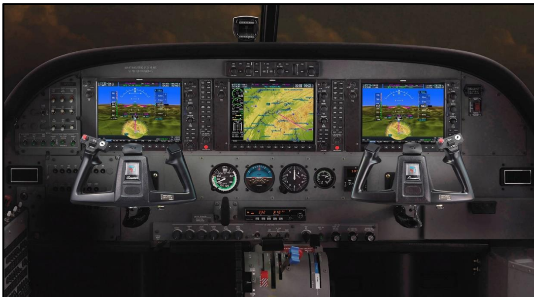
Figure 3. Système Garmin G1000 pour le Cessna Caravan montrant l'écran principal de vol (écrans gauche et droit) et l'écran multifonction (écran central) (Source : Textron Aviation)
