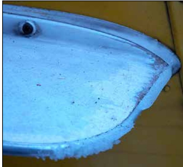
Figure 5. Givre sur une antenne du côté droit de la dérive
