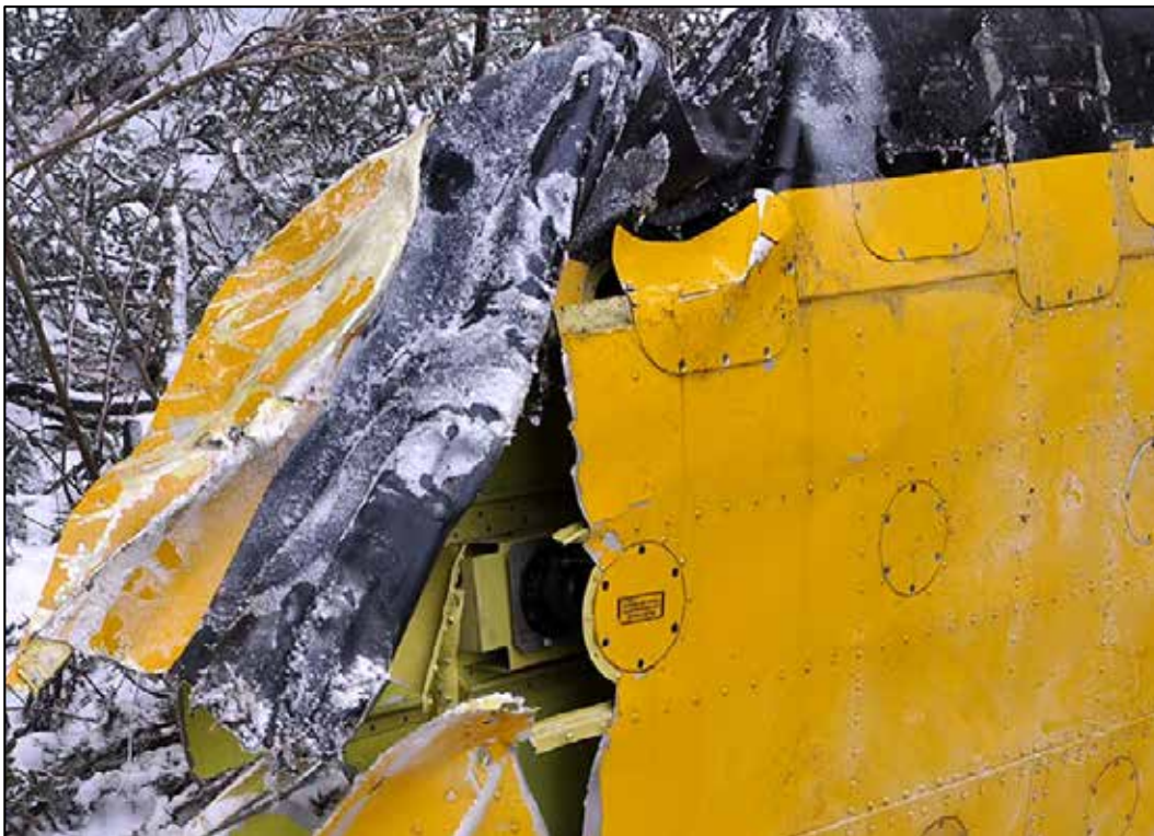
Figure 8. Givre sur le bord d'attaque de la partie extérieure de l'aile droite
