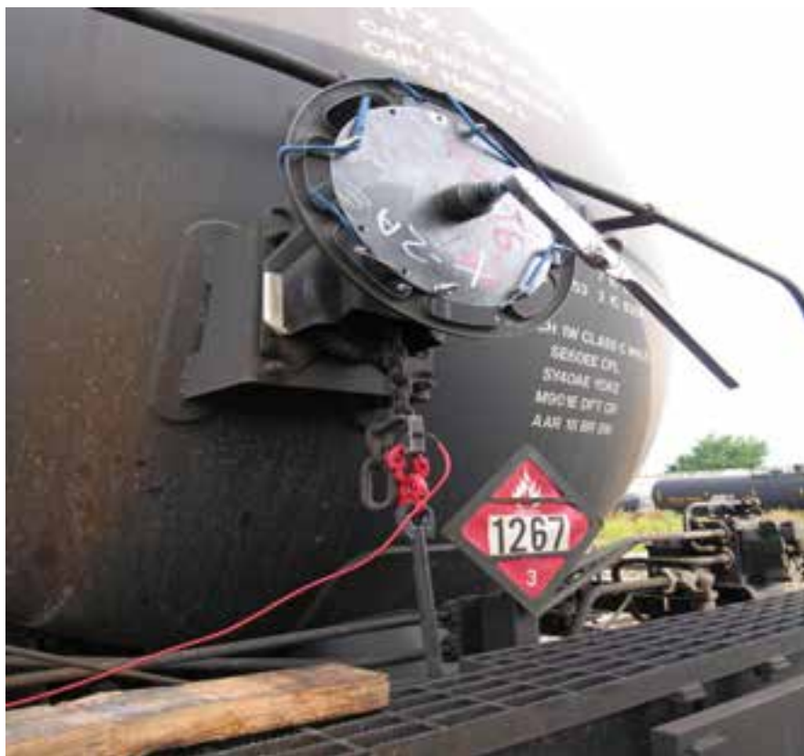
Figure 10: Capteur de tension de chaîne et plagemètre de couples, après leur insertion
